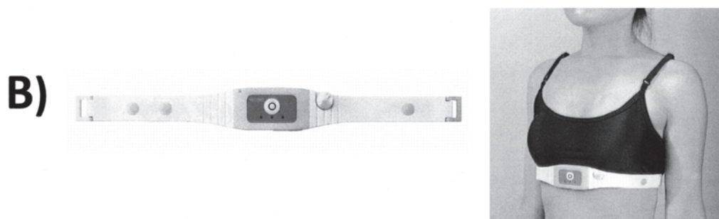
図1 B). 新しいタイプのイベント心電計 (Parama-Tech 社製 EV-101)。中央のボタンを押すと前後 30 秒間の心電図が記録される。1 週間の連続着用が可能で、数秒間の動悸に対しても心電図記録が可能である。
